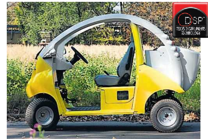
Samochód elektryczny "Elipsa" – napęd 2xBLDCM 2 kW, sterowany mikrokontrolerem sygnałowym TMS 320F2812 (2006r.).
